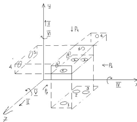
Эти шесть точек должны быть расположены в трех взаимно перпендикулярных плоскостях: опорные точки 1, 2, 3 в плоскости XOZ, две точки 4 и 5 в плоскости YOZ, и одна точка (6) в плоскости XOY. Координаты 1, 2, 3 определяют положение детали относительно плоскости XOZ.
