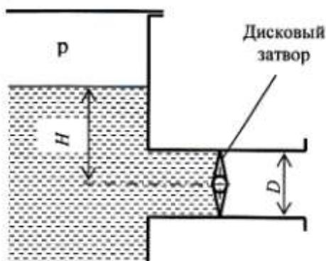
Закрытый резервуар с жидкостью плотностью  $\rho = 900$  кг/м<sup>3</sup> имеет выпускную трубу диаметром  $D = 0,5$  м, перекрытую дисковым затвором. Избыточное давление в резервуаре равно  $p = 8$  кПа, уровень жидкости находится над горизонтальной плоскостью, проходящей через ось затвора, на высоте  $H = 0,65$  м. Найти силу давления  $R$  на затвор и момент  $M$  этой силы относительно оси поворота затвора.
