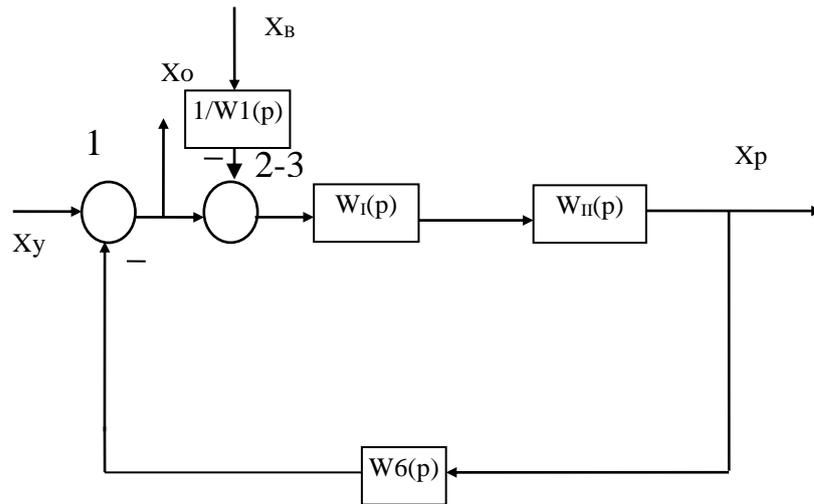
Объединив последовательно соединенные звенья  $W_I(p)$  и  $W_{II}(p)$ , получим эквивалентное звено с передаточной функцией  $W_I(p)W_{II}(p)$  и изобразим структурную схему в виде:
