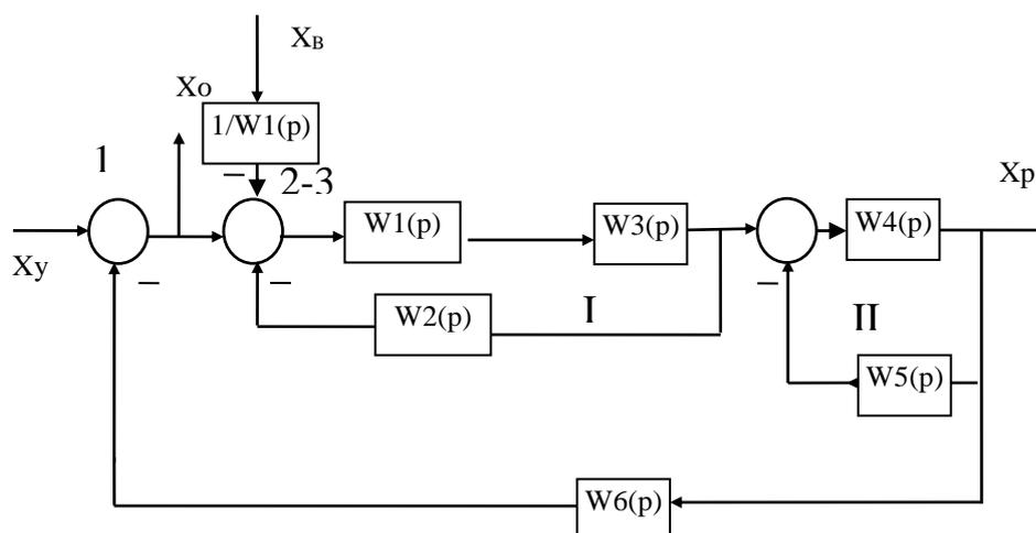
Заменим последовательно стоящие звенья  $W1(p)$  и  $W3(p)$  эквивалентным звеном  $W1(p)W3(p)$ , соединение **I** и **II** - эквивалентными звеньями с передаточными функциями:
