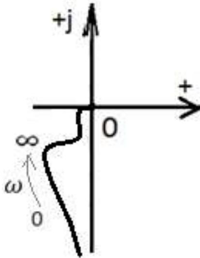
Ответ: В соответствии с заданной передаточной функцией системы автоматического управления построена АФХ.
