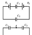
7.47. Определите разность потенциалов между точками A и B. Параметры электрической цепи  $\mathscr{E}_1$ ,  $\mathscr{E}_2$ ,  $C_1$ ,  $C_2$  заданы.
