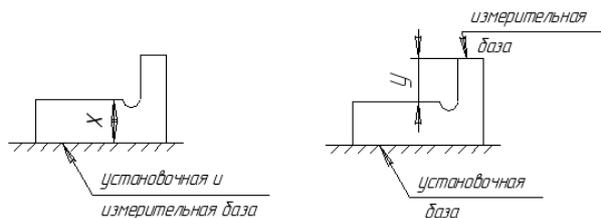
Установка детали для обработки может быть осуществлена различными способами:
