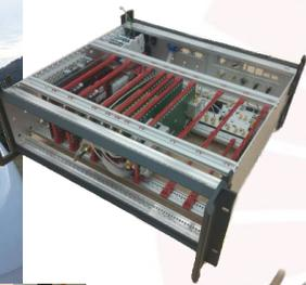
Приёмники квантово-оптических контрольно-корректирующих станций системы ГЛОНАСС
