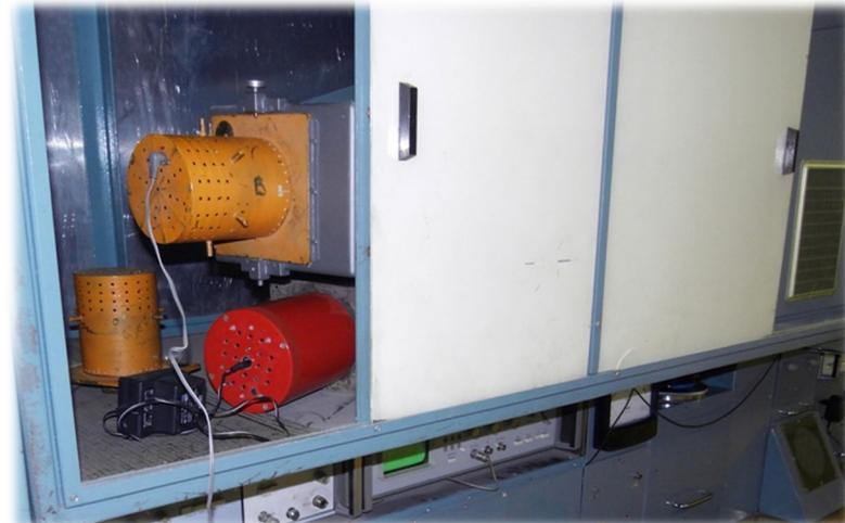
Безэховая камера с открытой дверцей. Видна вибраторная антенна, характеристики которой будут измерены (слева).
